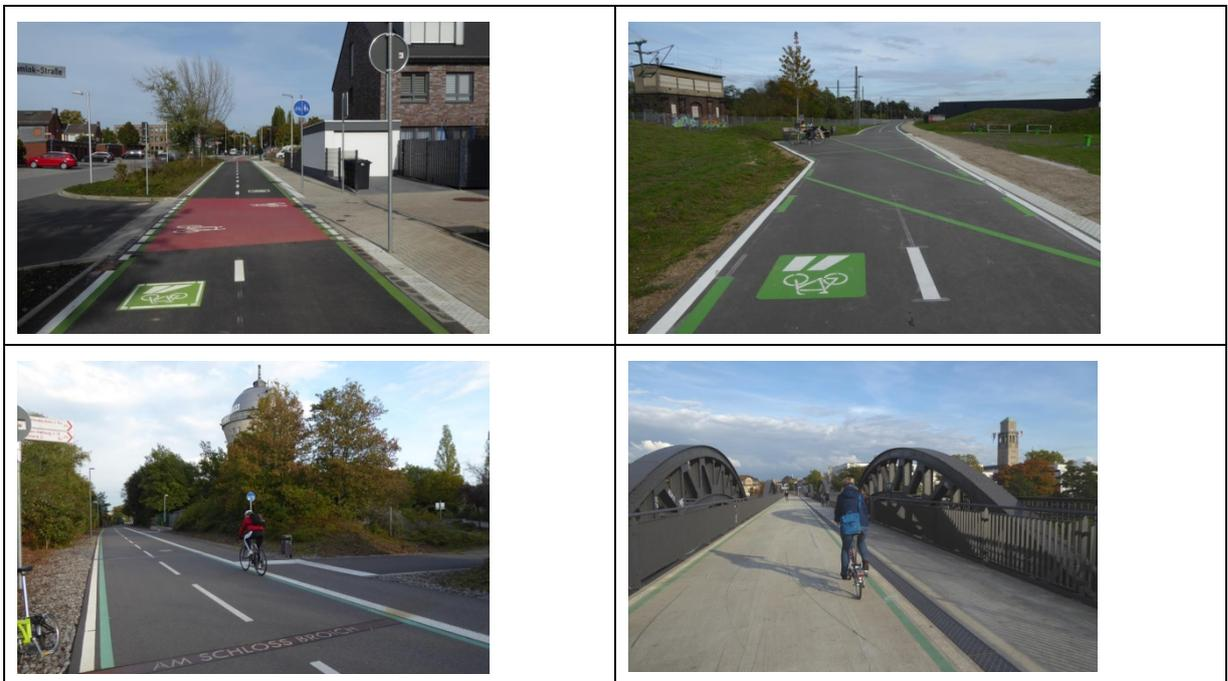
**Bild 4-1: Kennzeichnung einer Route auf neuen Radschnellverbindungen und Radvorrangrouten in NRW, Beispiele in Monheim, Krefeld und Mülheim a.d.R. (RS1)**
