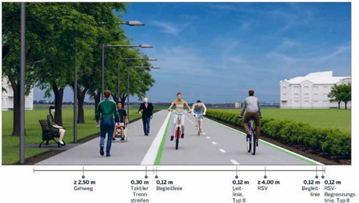
**Bild 1-20: Querschnitt einer eigenständig geführten Radschnellverbindung nach NRW-Standard (Quelle: Radschnellverbindungen in NRW. Leitfaden für Planung, Bau und Betrieb)**
